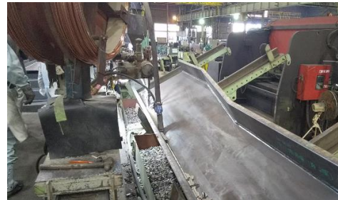
BH組立溶接（サブマージアーク溶接）
