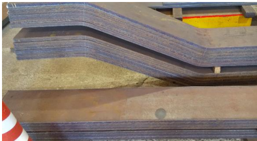
ハンチ付きBHの折曲げ加工
